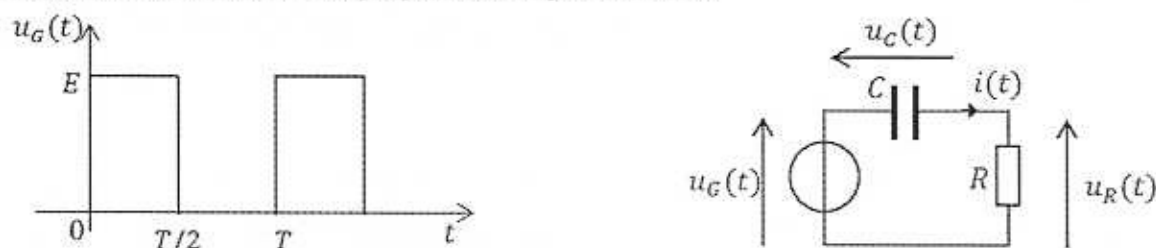
Figure 1. Signal d'entrée u_G(t) et schéma électrique du circuit
