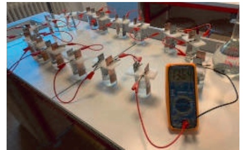
Figure 3. Photographie du montage exp rimental reconstituant la superposition de 16 cellules  l mentaires
